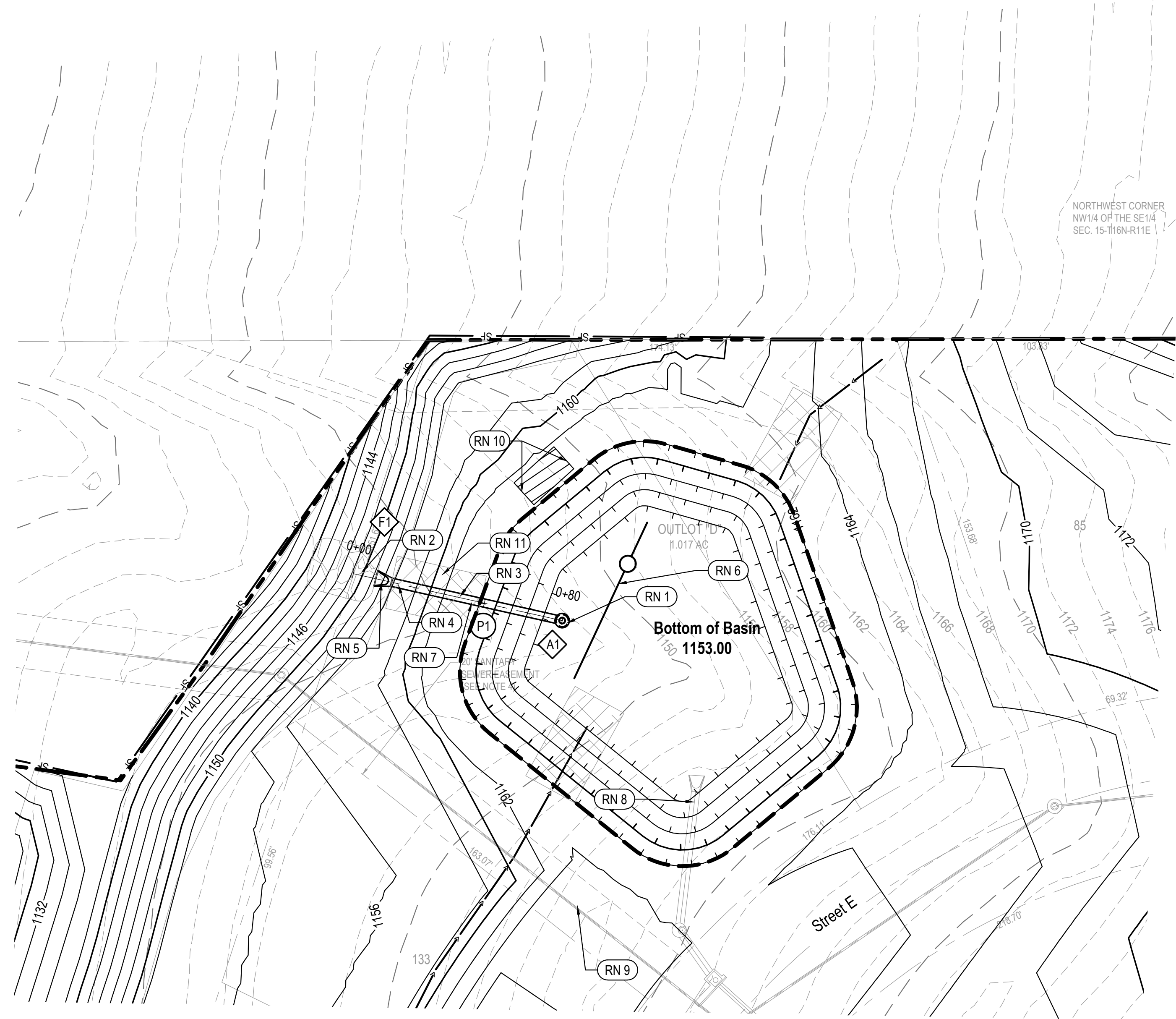
SEDIMENT BASIN A SCALE: 1" = 30'
